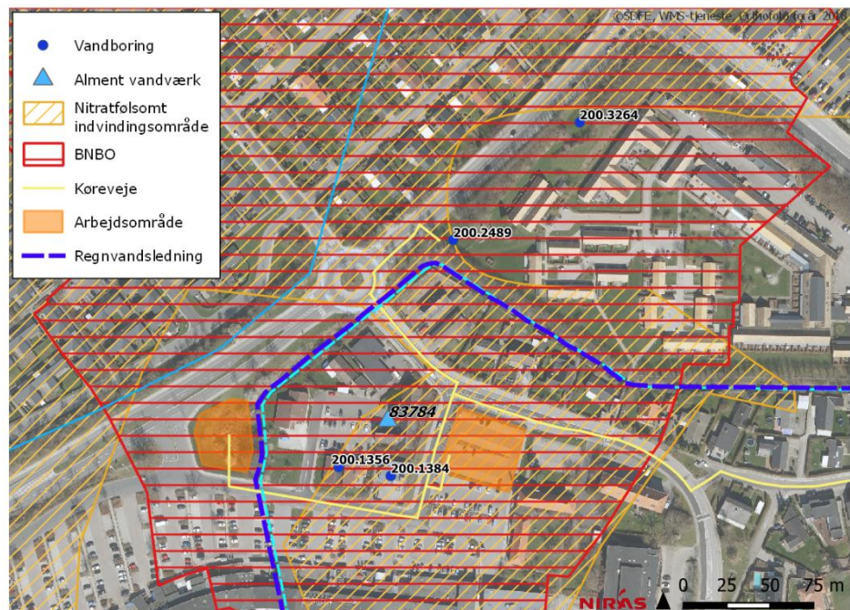
Figur 7.5: Smedebakken Vandværk (ID nr. 83784) og boring med DGU nr. 200.2489, der ligger nær tracéet for regnvandsledningen.
