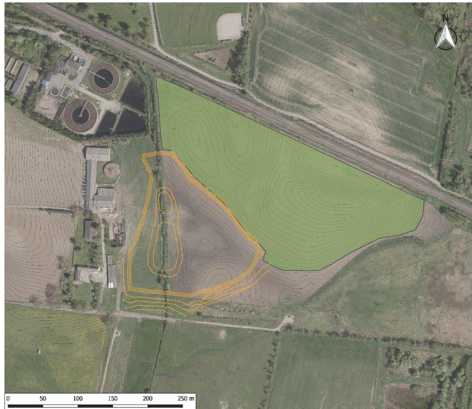
Figur 5.39: Illustration der viser jordbearbejdning i området med 0,5 m kurver. Det grønne område indikerer et område, hvor overskudsjord fra etablering af bassinet kan placeret på terrænet i et jordudlæg på 30 cm.
