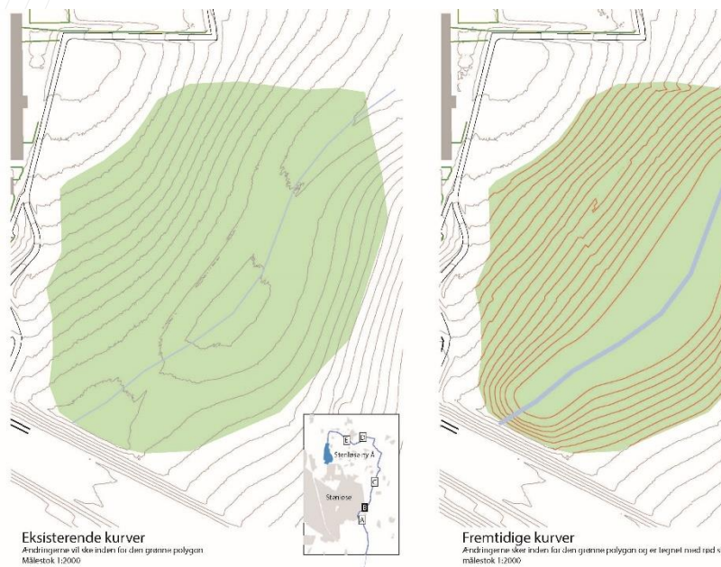
Figur 6.24: Illustration der viser, hvorledes terrænet vil blive bearbejdet i en løsning med en bred ådal.
