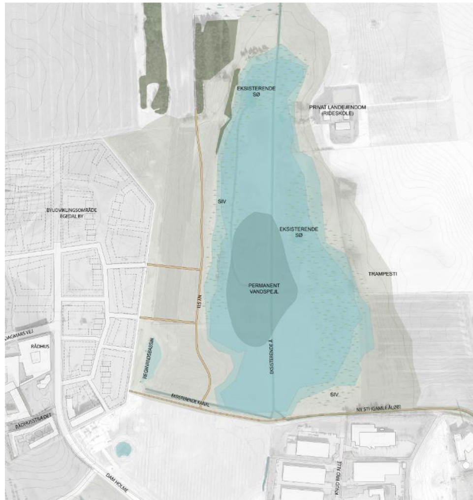
Figur 3.7: Bassin Nord inkl. stier (NIRAS). Lys blå viser udstrækningen af vandet, når bassinet er fuldt.
