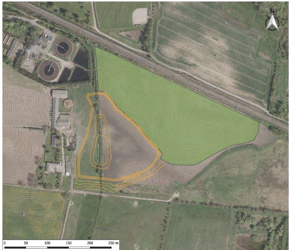
Figur 5.37: Illustration der viser jordbearbejdning i området med 0,5 m kurver. Det grønne område indikerer et område, hvor overskudsjord fra etablering af bassinet kan placeret på terrænet i et jordudlæg på 30 cm.
