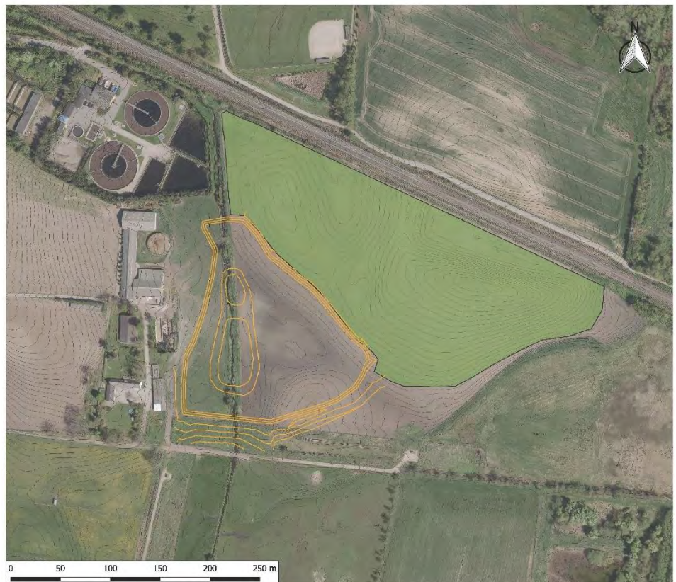
Figur 6.34: Illustration der viser jordbearbejdning i området med 0,5 m kurver. Det grønne område indikerer et område, hvor overskudsjord fra etablering af bassinet kan placeret på terrænet i et jordudlæg på 30 cm.
