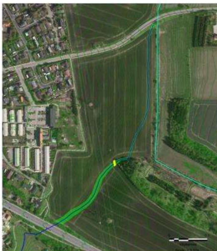
Figur 3.12: Trace mellem Søsumvej og Frederikssundsvej (løsning 1). Højdekurverne viser nuværende terræn.
