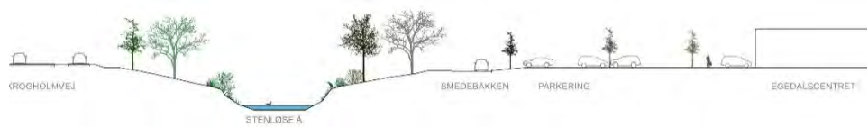
Figur 5.33: Det eksisterende regnvandsbassin ved Egedal Centret udvides, og der skabes et permanent vandspejl.
